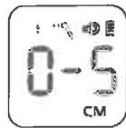
② Ja mērišanas attālums ir mazāks par 5 cm, ierīce automātiski veiks mērišanu, kad mērišana ir pabeigta tā vibrēs un atskanēs "pi" pīkstiens, un tiks parādīts mērijumu rezultāts.
